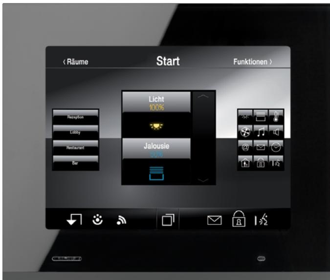
Los controles del edificio pueden ser gestionados a través del PC táctil KNX.
